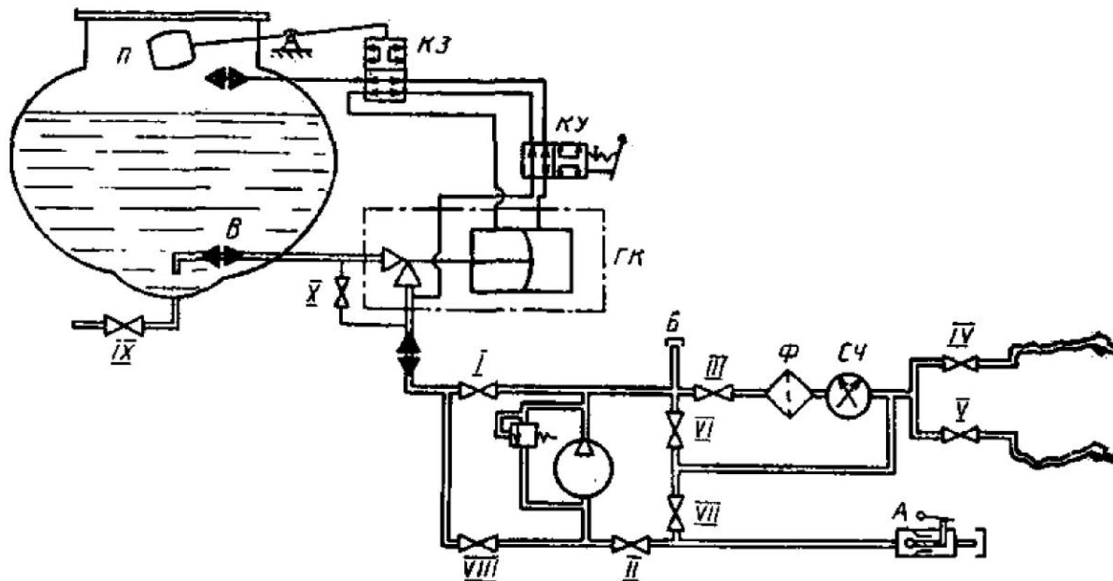
I-IX — задвижки; X — вентиль; А — напорно-всасывающий патрубок; Б — напорный патрубок; В — сливно-наливной трубопровод; ГК — гидроклапан; П — поплавок; КЗ — клапан золотниковый; КУ — кран управления; Ф — фильтр; СЧ — счетчик
